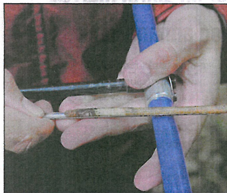
När provet borrats ut ur trädet undersöker forskarna årsringarnas bredd och densitet för att få indikationer om den historiska nederbörden.
